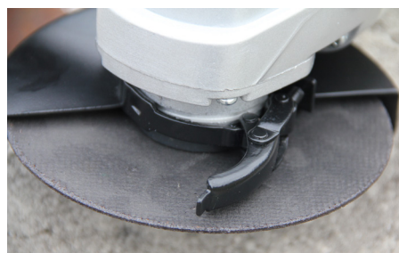
Кожух фиксируют эксцентриковым зажимом, без инструментов
