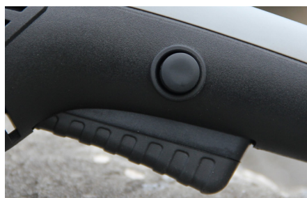
Пусковая кнопка без фиксации во включённом положении, с блокировкой случайного включения
