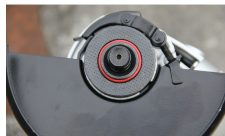
Некоторые называют это «суперфланцем». В каком-то смысле верно, он и впрямь не совсем обычный — с резиновым амортизирующим кольцом
