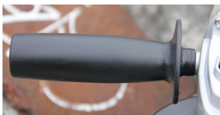
Передняя рукоятка обычная, без механизма подавления вибрации
