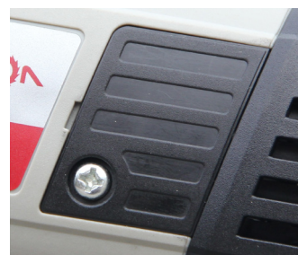
Лючок щёткодержателя. Замена щёток возможна без разбора корпуса
